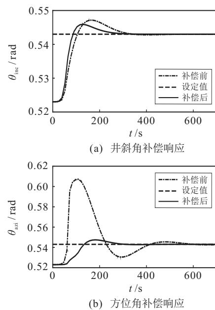
图4 井斜角和方位角的补偿响应比较
