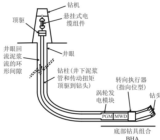
图1 定向钻进系统结构
