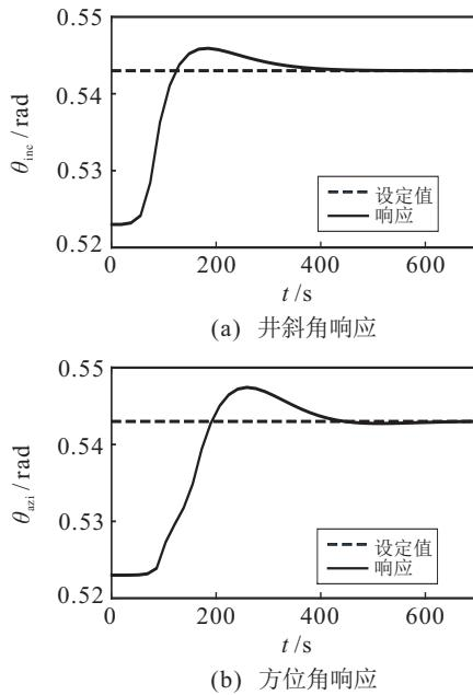
图3 井斜角和方位角的响应比较
