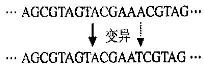
图 3 点变异操作的例子(A \rightarrow T) 6) 倒位:以一定的概率 P_i 从 DNA 群体 P(t+1) 中随机选取若干个 DNA 链个体,对于选中的 DNA 链个体,随机地选取某两个位置,将它们之间的碱基顺序进行倒位。倒位的目的是试图找到进化特性较好的基因顺序。倒位操作是可选的,根据问题的需要而定。倒位操作如图 4 所示。
