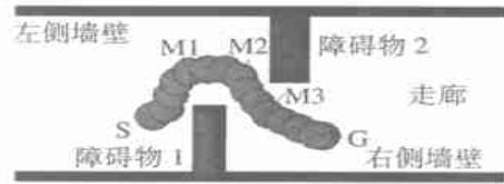
图 6 走廊中障碍环境下的机器人导航
