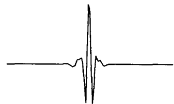
图 1 Coiflet 5 小波函数的时域波形
