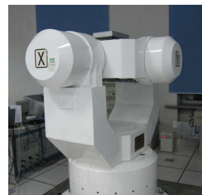
图2 三轴惯导测试转台
