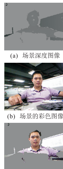
图 3 Kinect 深度信息和彩色信息及校正
