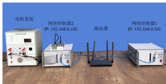
(a) 局域网云电机实际控制系统实物图
