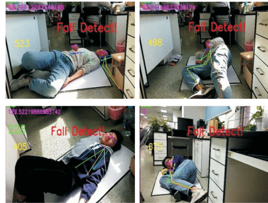
图5 相机在机器人设备上的检测结果
