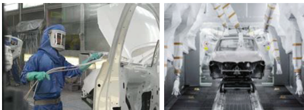
(a) 人工喷涂 (b) 机器人自动化喷涂
