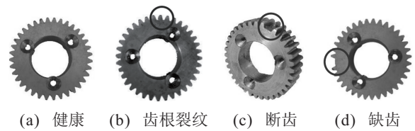
图7 行星轮故障实物图
