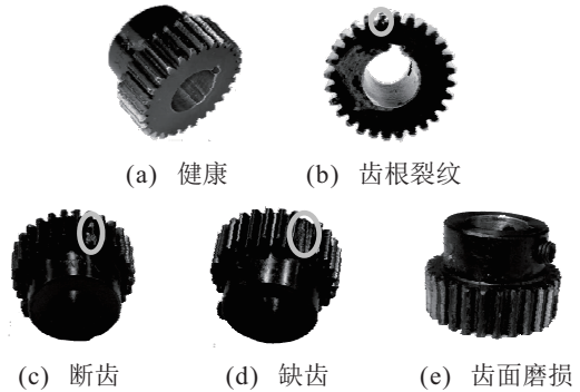
图6 太阳轮故障实物图
