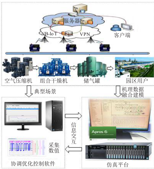
图4 空气压缩机群组仿真平台结构
