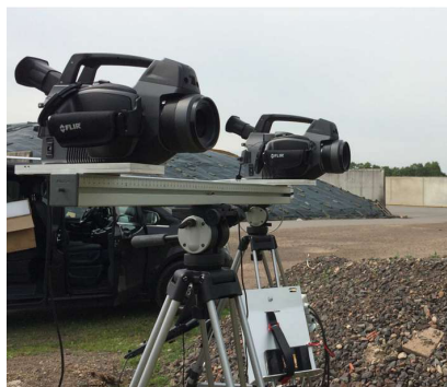
图13 双目立体OGI系统测量气体速度场 [109]
