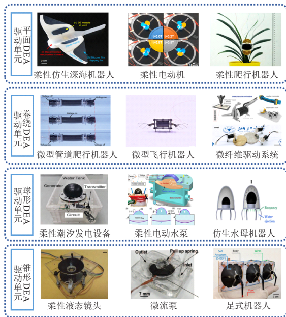
图3 不同结构的介电弹性体驱动系统及应用
