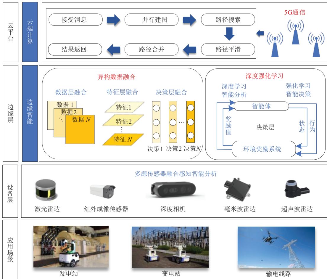
图 5 电力巡检机器人路径规划技术展望
