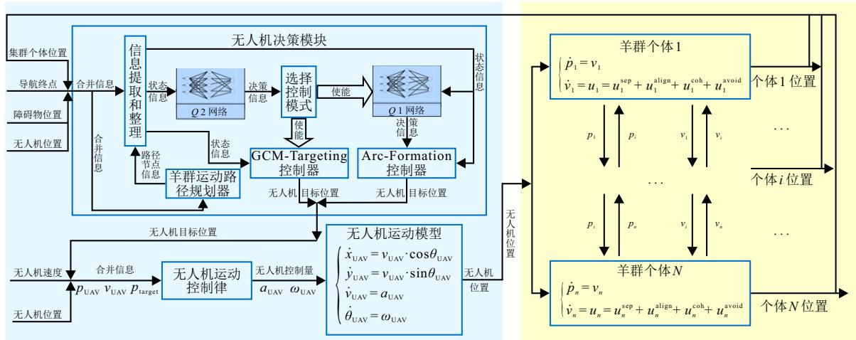
图2 分层 GCM-Arc 控制方法架构
