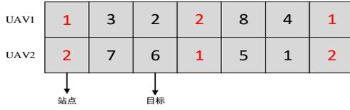
图 3 染色体编码方式示意图
