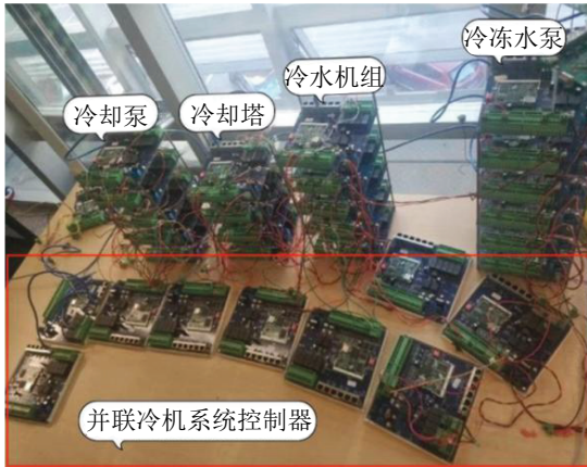
图3 并联冷机控制系统实验平台
