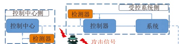
图4 针对 CPS 的攻击检测
